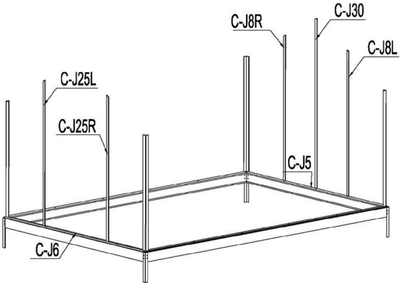
**ВНИМАНИЕ:** После завершения этого процесса вставьте 2 болта в раму C-J30. Вставьте 3 болта в каждую раму C-J8L, C-J8R, C-J25L и C-J25R для будущего использования.
